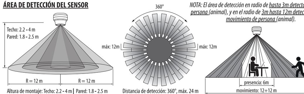
**NOTA: El área de detección en radio de hasta 3m detecta presencia de persona (animal), y en el radio de 3m hasta 12m detecta solamente movimiento de persona (animal).**
